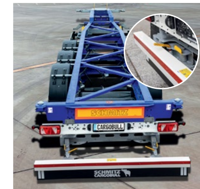
Neu konstruiert: herausfaltbarer Unterfahrerschutz für 45' Container ist einfacher und sicherer im Handling ohne lose Teile, die verloren gehen können.
