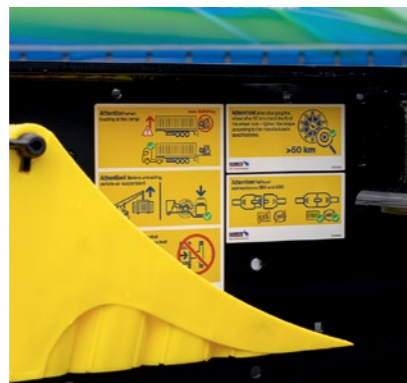
Neues Bedienkonzept mit Ladeplan und eindeutigen Funktions- und Warnhinweisen an Verriegelungen und Ausschüben.
