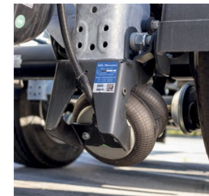
Die Liftachse* als Anfahrhilfe verlängert den Radstand und verstärkt damit den Druck auf die Antriebsachse. Unbeladen und in gelifteter Position reduziert sich der Reifenverschleiß.
