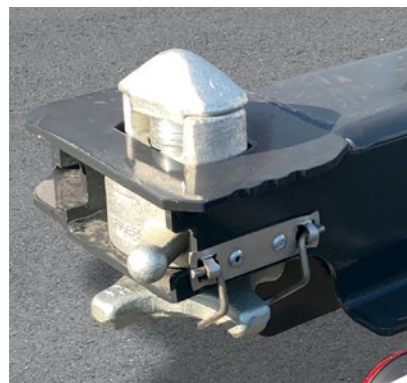
Standard TWIST LOCK Verriegelung: versenkbar und mit Verdrehsicherung
