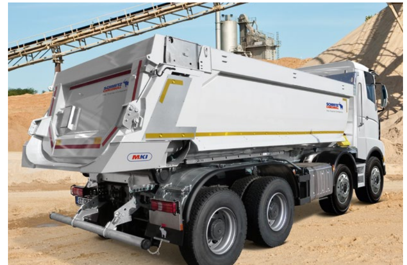
Die hydraulische Pendel-Klappe an den robusten Stahl-Rundmulden erlaubt das sichere Entladen auch sehr großer Steine.
